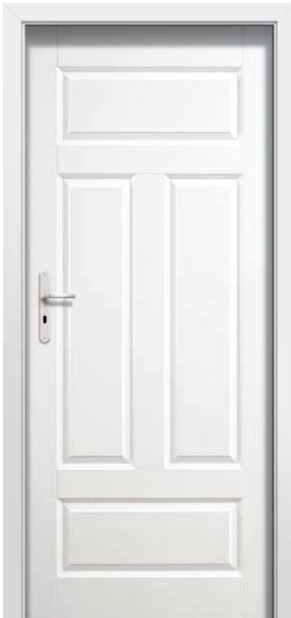
Die Türen sind aus einem Holzrahmen gefertigt, der mit zwei dreidimensionalen Platten mit einer mit umweltfreundlichen Acrylfarben aus den RAL und NCS-Farbsystemen beschichteten Oberfläche belegt ist. Füllung ist eine Lage mit „Wabenstruktur“.
