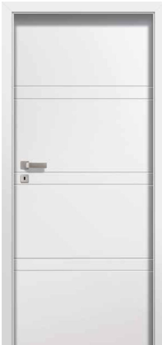
Die Türen sind aus einem Holzrahmen gefertigt, der mit zwei HDF-Platten mit gefrästen Zierlinien und einer mit umweltfreundlichen Acrylfarben aus den RAL und NCS-Farbsystemen beschichteten Oberfläche belegt ist. Die Ausfuchung besteht aus Vollspanplatte.
