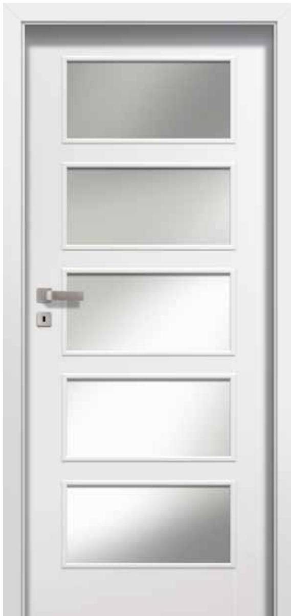
Die Türen sind aus einem Holzrahmen gefertigt, der mit zwei glatten HDF Platten mit einer mit umweltfreundlichen Acrylfarben aus den RAL und NCS-Farbsystemen lackierte Oberfläche verkleidet. Standardmäßige Füllung ist eine Lage mit „Wabenstruktur“.
