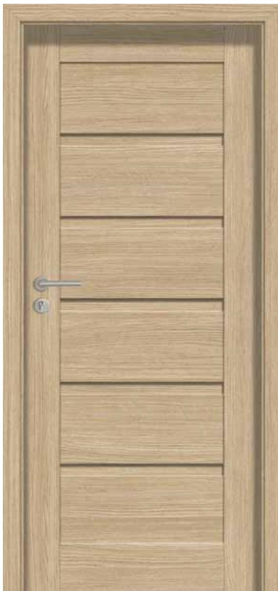
Die Türen werden auf der Basis eines Rahmens aus hochwertigem MDF gefertigt und mit einer ECO TOP, SILKSTONE Oberfläche belegt. Rahmen vertikale Maserung, Paneele horizontale Maserung, horizontale Maserung der Füllungen bei den Designmodellen W02, W03, W07, W08, vertikale Maserung bei den Designmodellen W05, W06. Die obere und untere Kante des Türflügels ist mit Furnier versehen.
