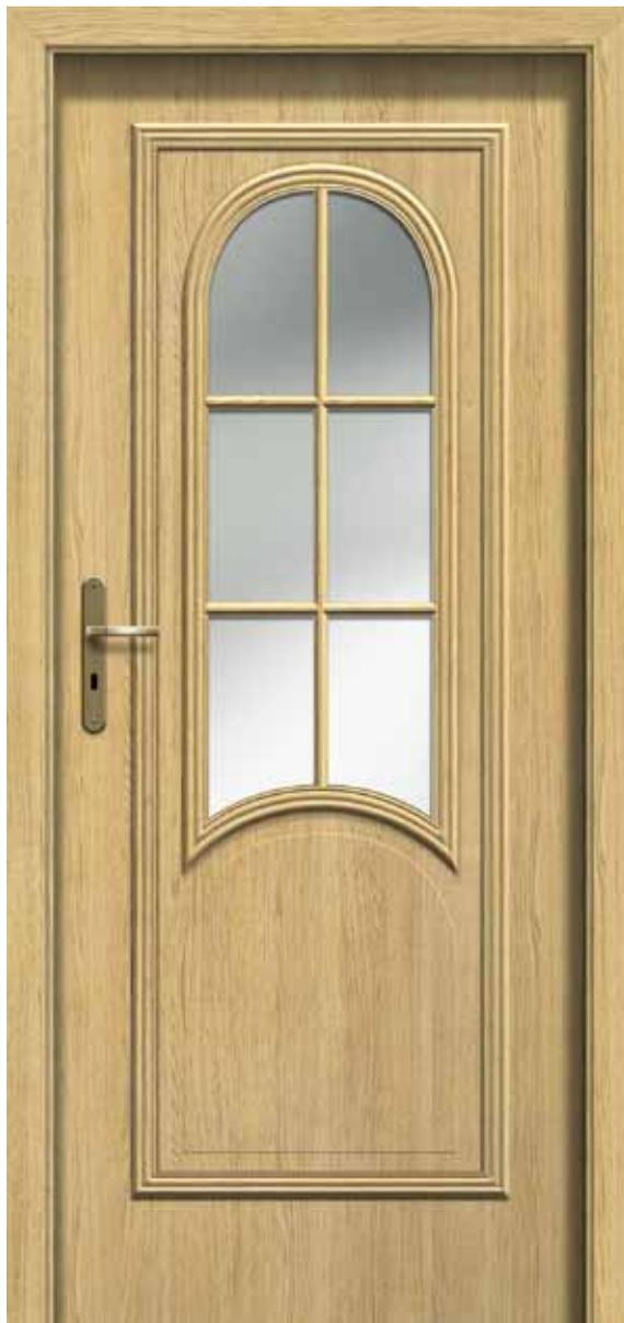
Die Türen sind aus einem Holzrahmen gefertigt, der mit zwei glatten HDF-Platten belegt ist, die mit natürlichem Furnier belegt sind. Die Maserung des Rahmens und der gefrästen Füllungen ist vertikal. Standardmäßige Füllung ist eine Lage mit „Wabenstruktur“.
