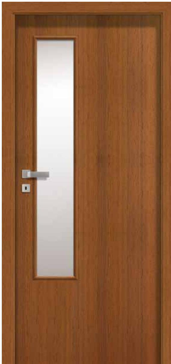
Die Türen sind aus einem Holzrahmen gefertigt, der mit zwei glatten HDF-Platten belegt ist LAMISTONE CPL, SILKSTONE. Standardmäßige Füllung ist eine Lage mit „Wabenstruktur“.
