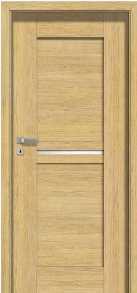
Die Türen sind aus einem Holzrahmen gefertigt, der mit zwei glatten HDF-Platten belegt ist, die mit natürlichem Furnier belegt sind. Die Maserung des Flügelrahmens ist vertikal, die Füllungen und Paneele sind, abhängig vom Designmuster, horizontal oder vertikal gemasert. Die Flügel können auch einseitig mit einer Magnettafel (Z/AZ) oder einem einseitigen Spiegel (WL Z, WL A/Z) ausgestattet werden.
