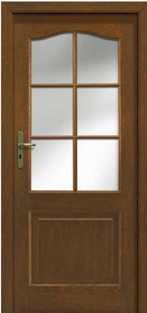
Die Türen sind aus einem Holzrahmen gefertigt, der mit zwei glatten HDF-Platten belegt ist, die mit natürlichem Furnier belegt sind. Türfüllung gefräst, Rahmen und Füllungen furniert.
