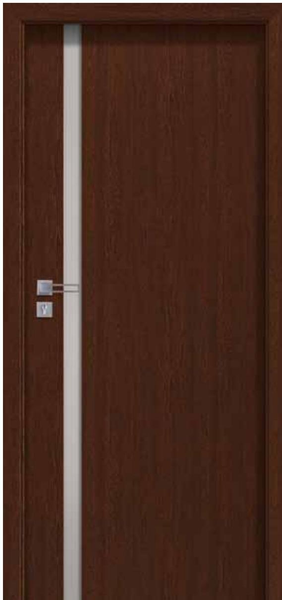
Der Türflügel besteht aus Rahmenholz, das beidseitig mit naturholzfurnierten HDF-Platten abgedeckt ist. Füllung aus Vollspanplatte. Die Designmuster A01, A02, A03 beinhalten eine vorgespannte 6 mm starke mattweiße Glasscheibe. Im Falztürsystem weist die Flügeloberkante einen Falz auf.
