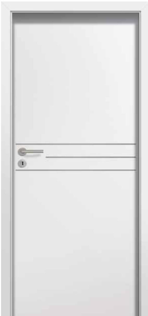
Die Türen sind aus einem Holzrahmen gefertigt, der mit zwei glatten HDF Platten mit einer mit umweltfreundlichen Acrylfarben aus den RAL und NCS-Farbsystemen lackierte Oberfläche verkleidet. Die Ausfachung besteht aus Vollspanplatte. Auf der Oberfläche des Türflügels Aluminium-Dekorleisten in Farbe Chrom matt oder Schwarz.
