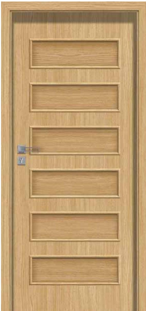
Die Türen sind aus einem Holzrahmen gefertigt, der mit zwei glatten HDF-Platten belegt ist ECO TOP, HIGH TOP. Standardmäßige Füllung ist eine Lage mit "Wabenstruktur". Die Maserung ist auf der Flügeloberfläche vertikal und auf den Paneelen, abhängig vom Designmuster, vertikal (Design A) oder horizontal (Design C, F).
