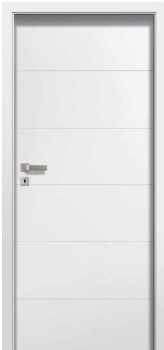
Die Türen sind aus einem Holzrahmen gefertigt, der mit zwei glatten HDF Platten mit einer mit umweltfreundlichen Acrylfarben aus den RAL und NCS-Farbsystemen lackierte Oberfläche verkleidet. Standardmäßige Füllung ist eine Lage mit "Wabenstruktur". Die Oberfläche des Türflügels verzieren waagerechte gefräste Zierelemente.
