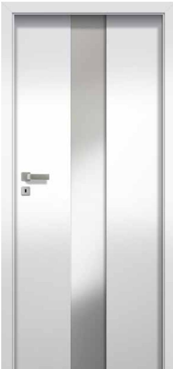
Die Türen sind aus einem Holzrahmen gefertigt, der mit zwei lackierten HDF-Platten verkleidet ist. Gefräste Zierelemente in den Designmodellen B1, B2, B3. Die Designmodelle A01, A02, A03 besitzen eine thermisch vorgespannte 6 mm dicke matte Weißglasscheibe. Im Falztürsystem weist die Flügeloberkante einen Falz auf.
