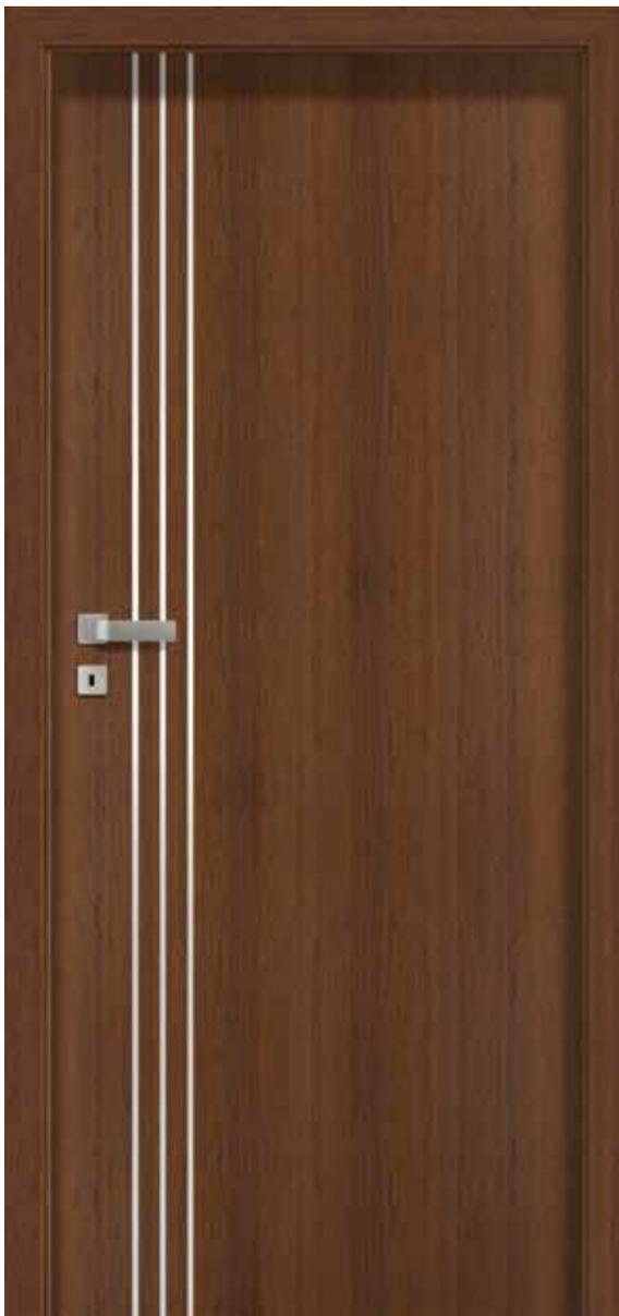
Die Türen sind aus einem Holzrahmen gefertigt, der mit zwei glatten HDF-Platten belegt ist LAMISTONE CPL, SILKSTONE. Die Version mit H Maserung kommt nur auf der Türblattfläche vor. Standardmäßige Füllung: Schicht mit „Wabenstruktur“ in den Versionen A01, A02, A03, B0, Vollspanplatte in den Versionen B1, B2, B3, B4. Fehlender oberer Falz sowohl im Falztürsystem als auch bei ungefälzten Türen.
