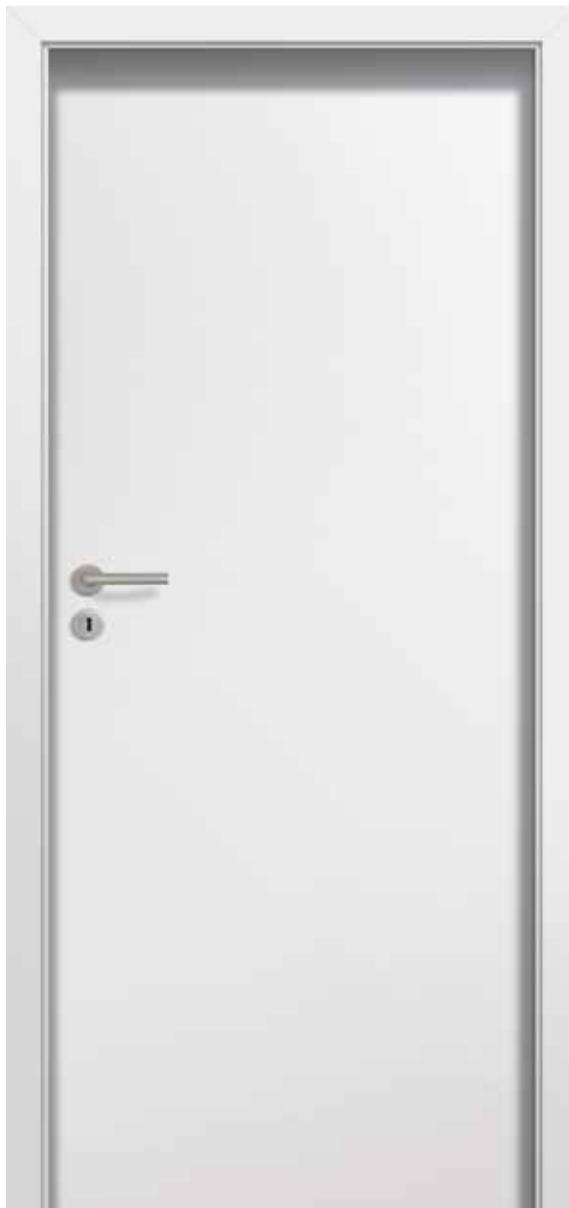
Die Türen sind aus einem Holzrahmen gefertigt, der mit zwei glatten HDF Platten mit einer mit umweltfreundlichen Acrylfarben aus den RAL und NCS-Farbsystemen lackiert Oberfläche verkleidet. Standardmäßige Füllung ist eine Lage mit „Wabenstruktur“.
